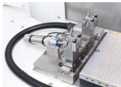
**Profilatore ribaltabile** per la ravnatura fascia e fianco mola e profili. Grazie all'azionamento pneumatico, si evita ogni possibilità di collisione tra la mola e il suo carter di protezione ed il ravnatore.
