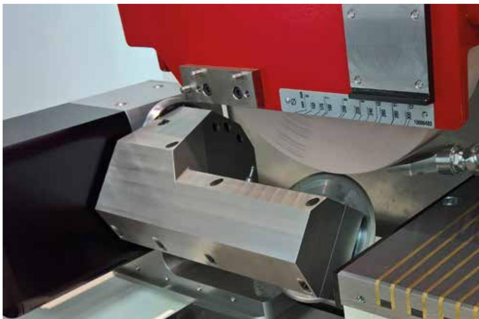
**Profilatore basculante** PA-T130, posizionato a sinistra del piano magnetico, per la realizzazione di profili ad elevatissima precisione e cambio utensile rapido. Messa a punto automatica dei rulli diamantati (profondità profilo fino a 30 mm).
