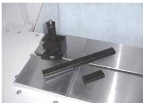
**Portadiamante** con inserti intercambiabili (90, 150, 300 mm) per una efficiente ravnatura perimetrale e laterale, nonché per la calibrazione.
